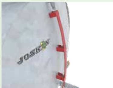
Защищенный индикатор уровня, вне зоны доступа для животных.
